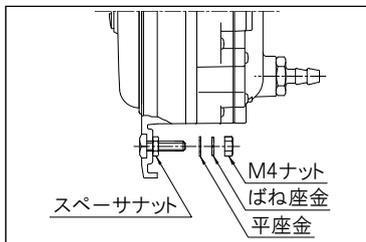
1. 本器の角形取付枠の4隅より、M4ナット、ばね座金、平座金を取り外してください。(図のスペーサナットを外さず、必ず付けたままで本器を取り付けてください。)
