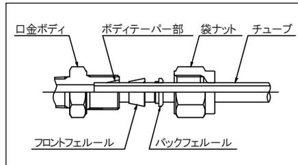
1. 口金の各部品が上図の通り正しく装着されているか確認した後、チューブ端がボディ奥に当たるまで差し込んでください。
