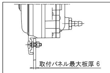
2. 本器をパネルに取り付けた後、平座金、ばね座金、M4ナットの順に、裏面より締め付けてください。
