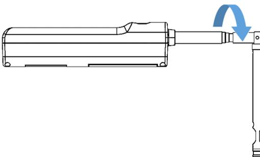
※キャリングケースへの収納時はプローブ先端を電池カバー側に 90 度倒してL 型に固定します。
