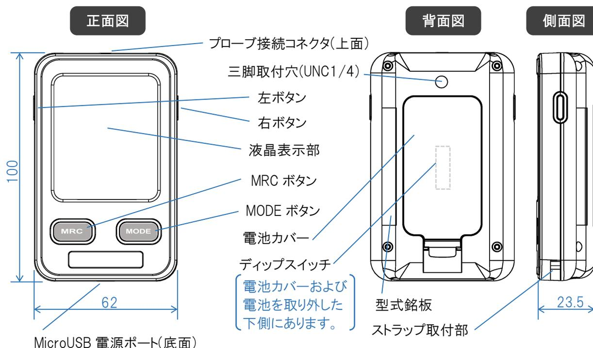
USB のバスパワーもしくは市販の USB タイプの AC アダプターから電源供給を行うことができます。このとき表示ユニットとプローブを有線ケーブル接続していれば、プローブ側へも電源供給されます。通信ポートとしては機能しません。
