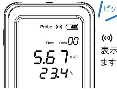
(●●) が点滅し、接続後計測値が表示され、計測モードに移行します。
