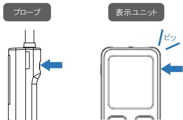
液晶およびバックライト(プローブ LED)が点灯する
