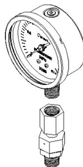
テーパユニオン型圧力配管用の継手です。テーパ接続でもユニオンにて接続が可能です。
