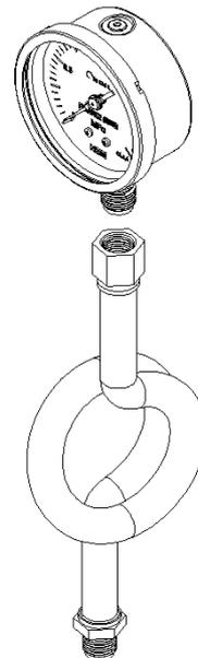
蒸気圧測定等高温の場合に使用します。
