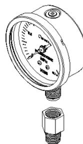
異径ネジ接続、異種ネジ接続の場合に使用します。
